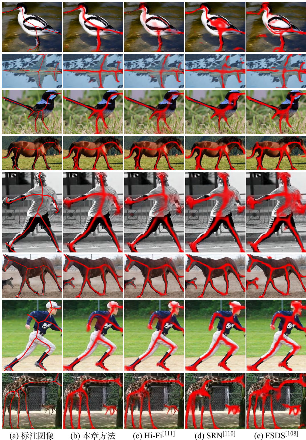
图 5.13 与三种领先且具有代表性的骨架提取方法的视觉结果对比。很容易发现，本模型的结果比其他三种方法要细得多，且有着更高的置信度。此外，本模型的预测结果中的骨架是连续的，这对于实际的应用来说是至关重要的。
