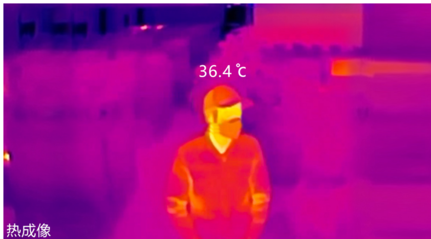
图 1.1 结合热成像摄像机和 AI 技术进行体温检测 (图片来源web)
